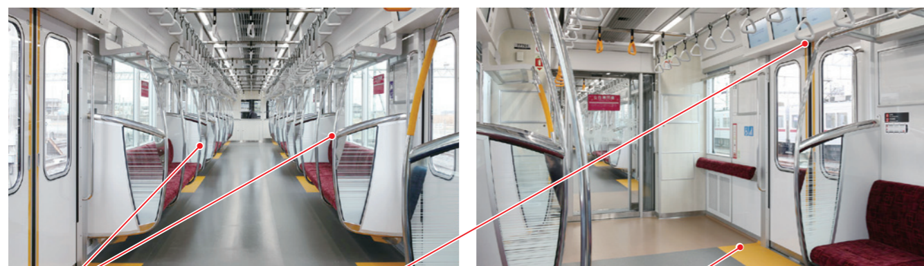
POINT スタンプポール POINT 扉開閉予告灯 POINT ドア開口部の床の識別色(黄色)
